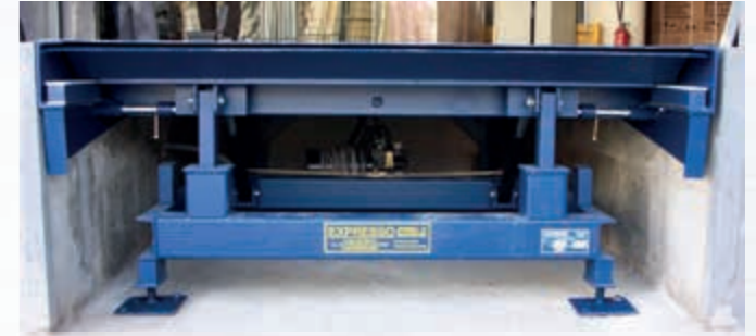
Lèvre télescopique sortie, course 500 mm. Les béquilles d'appui articulées facilitent le rangement de la lèvre, surtout à partir d'une position de travail négative
