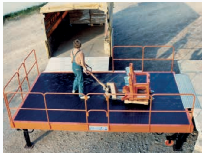
Béquille télescopique à manivelle munie de roulettes
