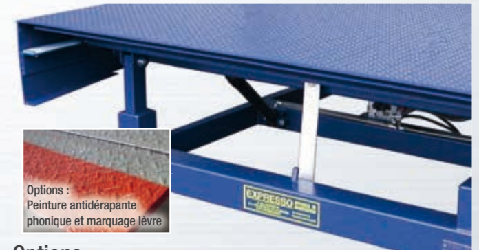
Lèvre télescopique sortie, course 500 mm. Les béquilles d'appui articulées facilitent le rangement de la lèvre, surtout à partir d'une position de travail négative
